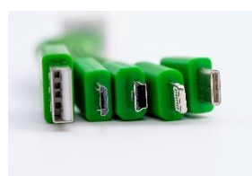
USB-Stecker (in unterschiedlichen Formen): digitale Daten und Signale (z.B. von der Tastatur) Stromversorgung
